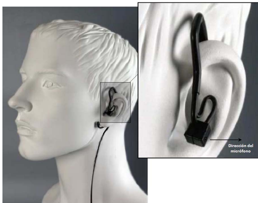
Figura 2. Micrófono de presión en miniatura SV25S. (Derecha) Posicionamiento en el oído externo de la cabeza 1 del oyente.
